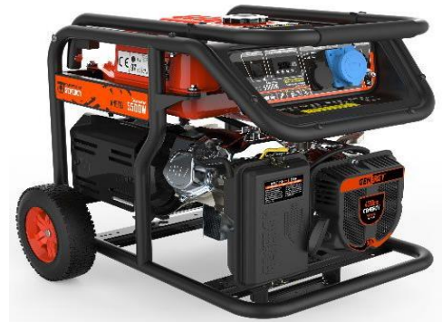
GENERADOR 5500W MOD. ANETO SISTEMA ESTABILIZACION ELECTRONICA AVR 420cc 79kg MONOFASICO CONSUMO 25-50-75% = 1,60-2,10-2,50 L/H GEN004
