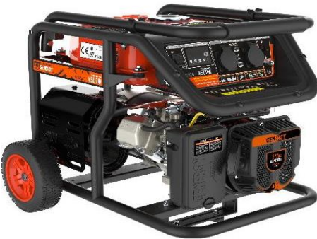
GENERADOR 4500W MOD. MONCAYO SISTEMA ESTABILIZACION ELECTRONICA AVR 272cc 55kg MONOFASICO CONSUMO 25-50-75% = 1,24-1,78-2,34 L/H GEN001
